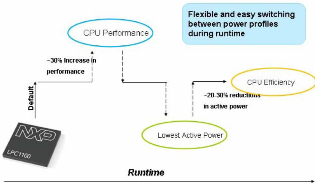
图 1 典型电源配置的流程
