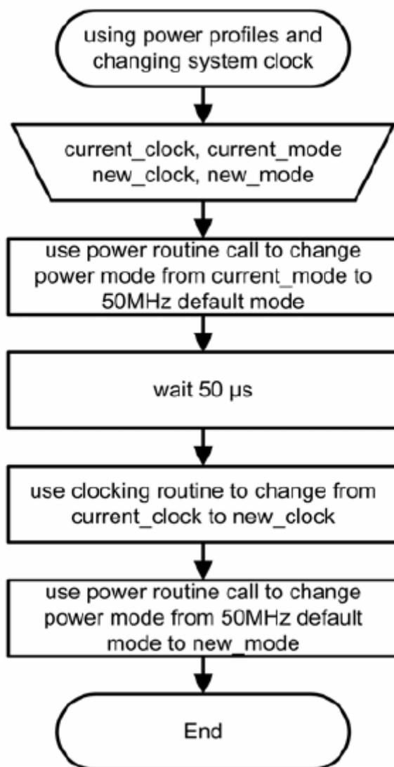
图 5 简化的电源配置使用流程框图
