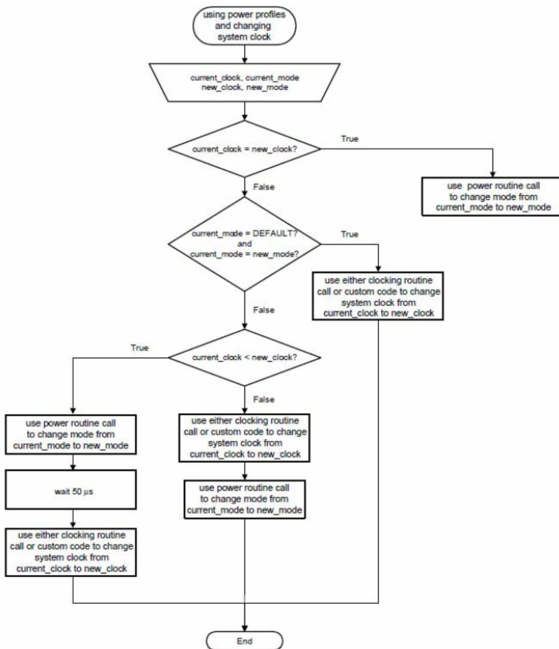
图 4 电源配置流程图（来自 LPC1100L 用户手册）
